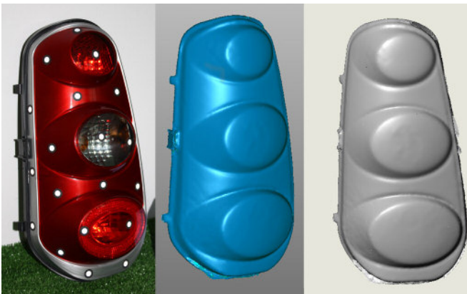
3D-Scan einer smart-Rückleuchte
